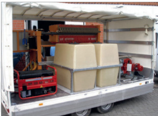
Von links: Stromerzeuger, Klarwassertanks, Schlamm-pumpe
